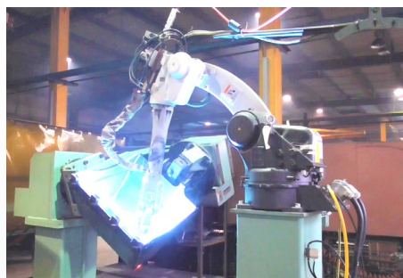
溶接ロボット
